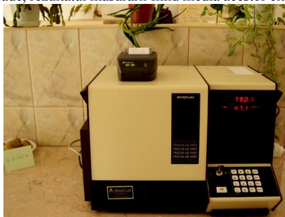
Fig. 2 – Sistem computerizat pentru determinarea substanței uscate și a amidonului
